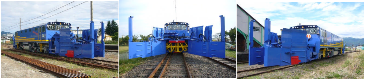
最新鋭の除雪車（1台でロータリーとラッセルの機能を持つ）
